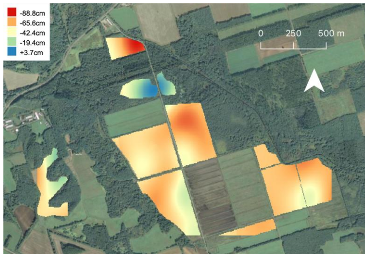
図2 クリギングにより算出された地下水位分布図
