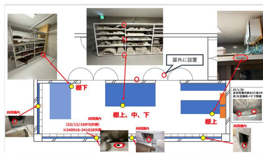
図 3-4 温湿度データロガー設置状況 (2025 年 1 月 30 日～)
