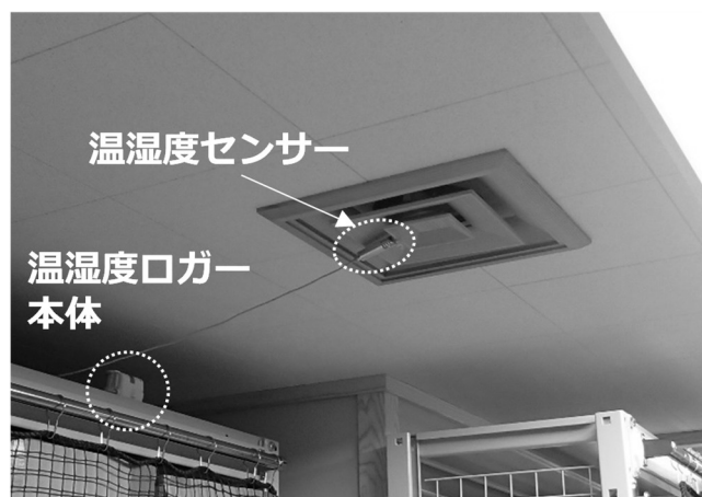
図 2-3 収蔵庫内の温湿度測定の様子（収蔵庫 2）
