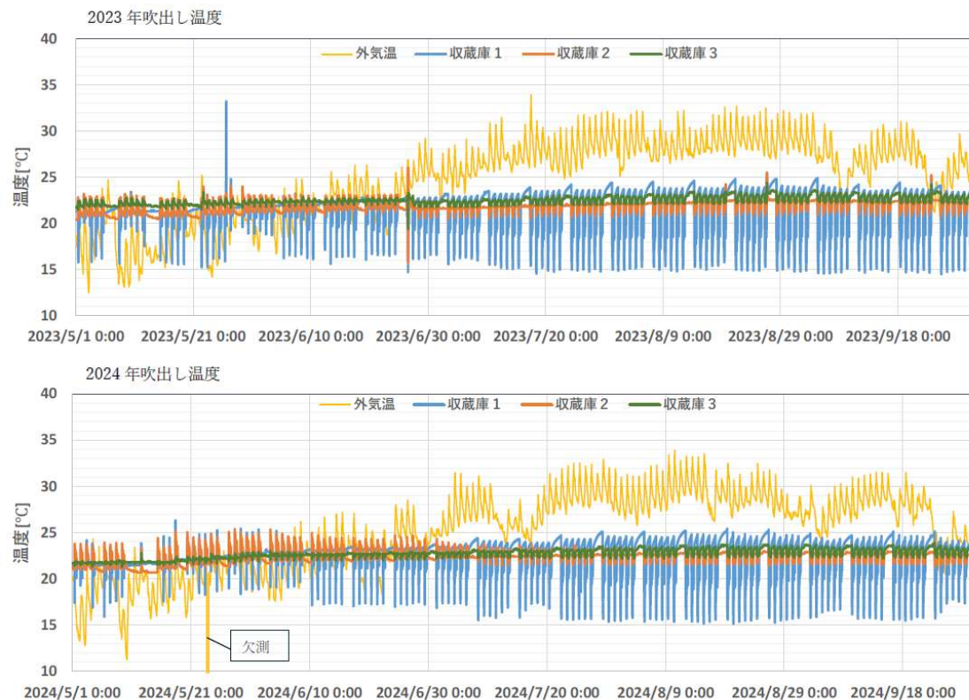
図 2-4 夏季の収蔵庫の空調吹出口の温度 (上) 2023/5/1-2023/9/30 (下) 2024/5/1-2024/9/30
