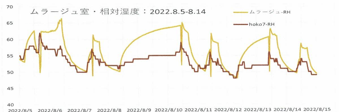
図 A-5-3 窓気密化後の収蔵室・収蔵容器内の相対湿度変化（2022年8月5日～8月14日）
