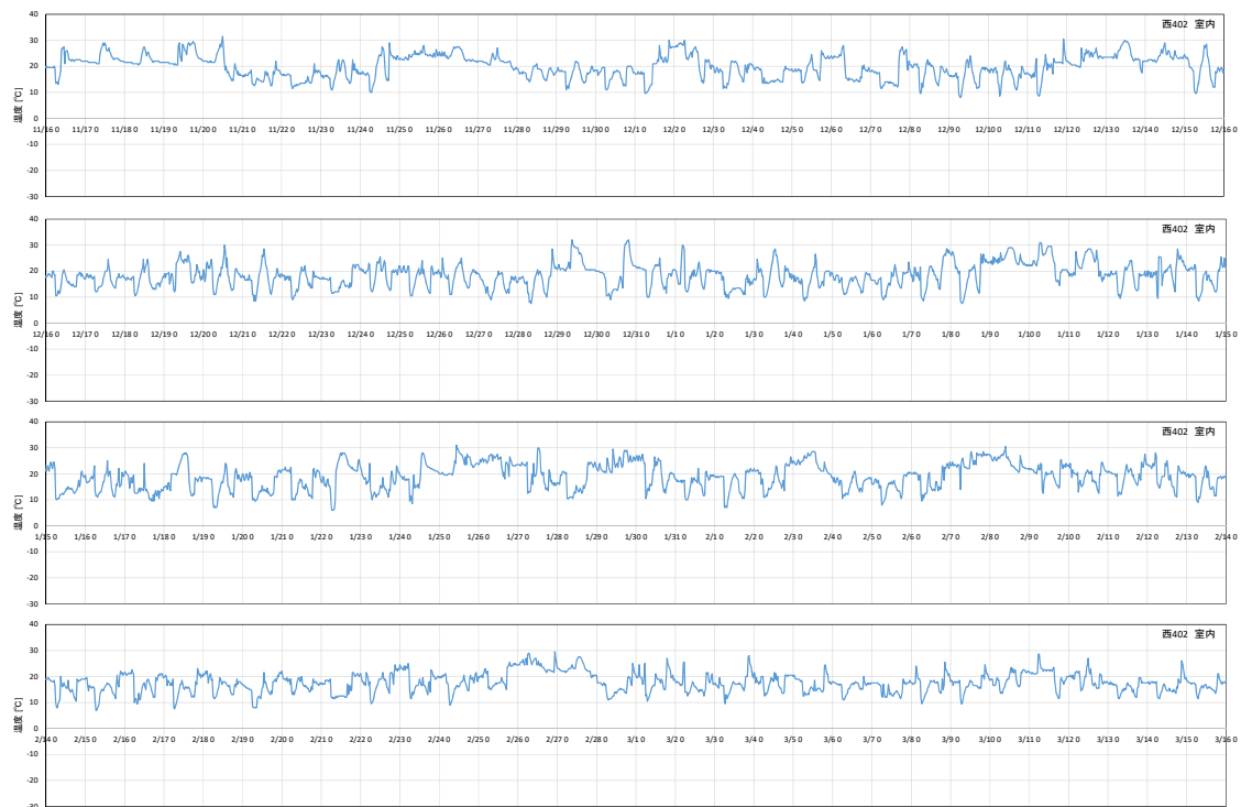
図 3.17 西 402 室内側排気口周辺空気温度
